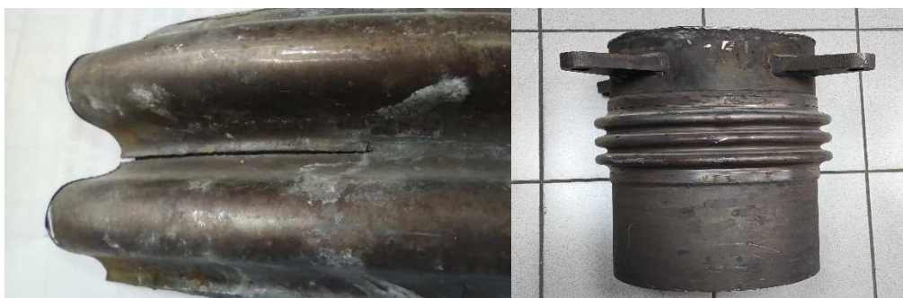
Рис. 1. Сильфонный компенсатор и продольный разрыв на сильфоне
