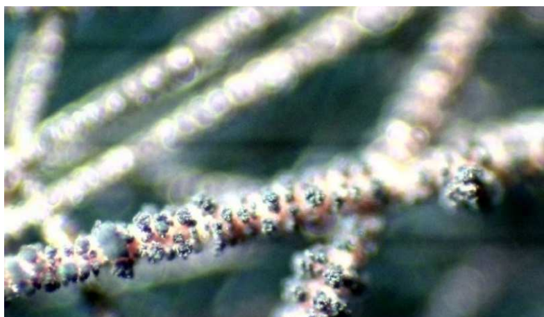
Рис. 5. Углеволокнистая вуаль с электрохимически нанесенным Fe и Ni под микроскопом
