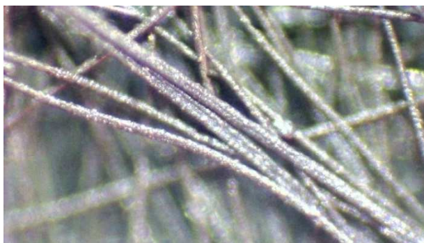
Рис. 3. Цементит, повторяющий структуру исходной вуали
